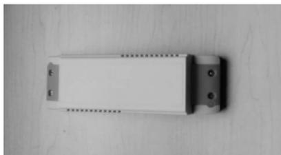
Unidad Recepción: Entrada alimentación 230 VCA y salida de 230 VCA controlada por relé para conexión a campana o extractor de aire.
