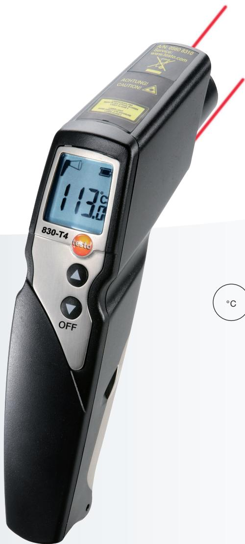
El testo 830 es un termómetro por infrarrojos para la medición de la temperatura superficial sin contacto apto para todo tipo de aplicaciones. Tanto para sector comercial como para la industria. Gracias al nuevo procesador que permite mayor resolución, ahora se pueden hacer mediciones aún más exactas. La temperatura se puede medir con una exactitud de hasta 0.1 °C. Gracias a la función min./max. se pueden visualizar y controlar los valores límite de la última medición.
